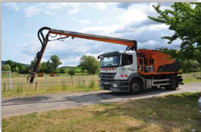
Le « point-à-temps » : technique de réparation ponctuelle de la chaussée, là où elle a subi des dégradations tels que des nids de poule.
